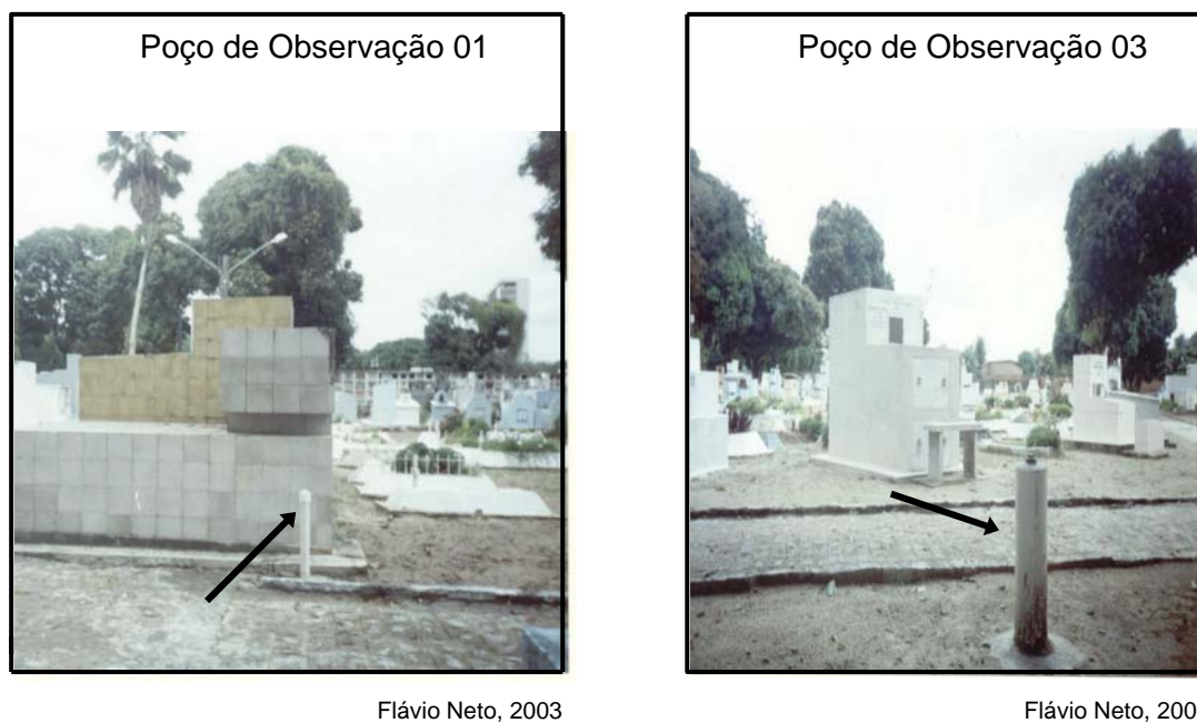
Figura 14 - POÇOS DE OBSERVAÇÃO CONSTRUÍDOS NO CEMITÉRIO DA VÁRZEA.
